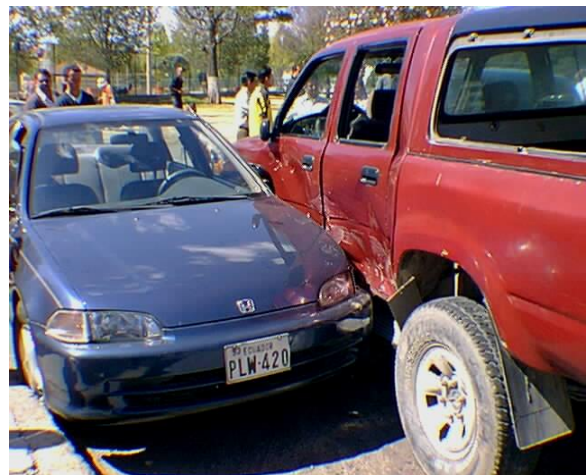
Figura 72. Roce positivo. Daños en pintura y plancha metálica.
