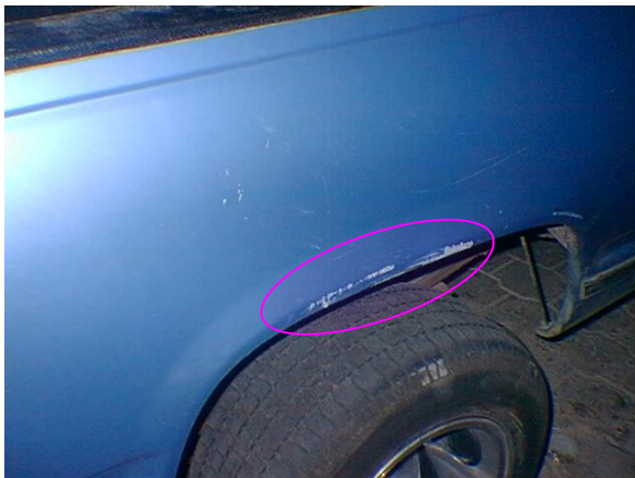
Figura 20. Rozamiento. Afectación de capa de pintura.
