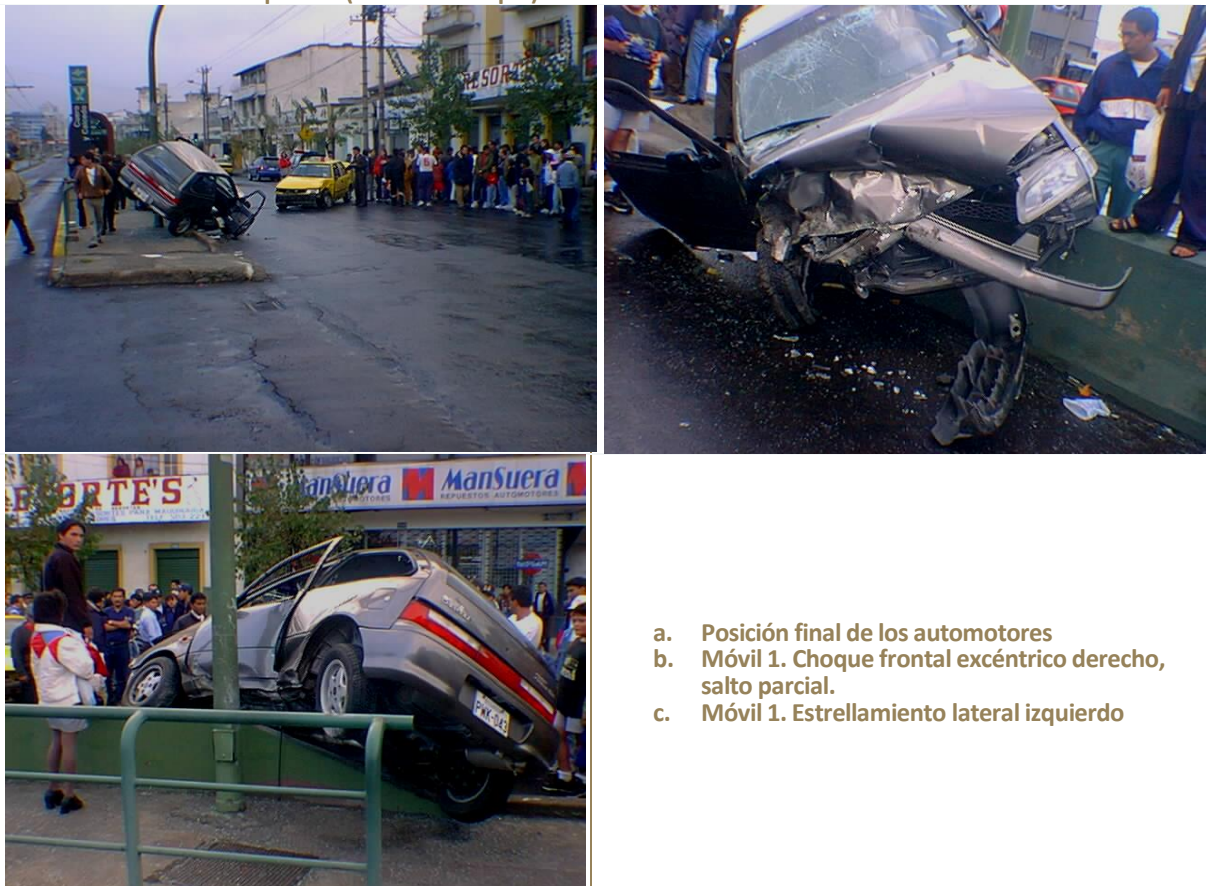
Figura 77. Accidente mixto. Choque frontal excéntrico derecho (accidente múltiple), salto parcial (accidente simple) y estrellamiento lateral izquierdo (accidente simple)
