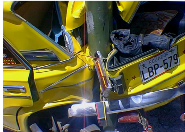
Figura 18. Estrellamiento posterior contra un poste (semáforo).
