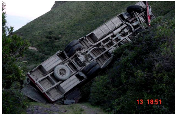
Figura 3. Volcamiento longitudinal tipo campana anterior
