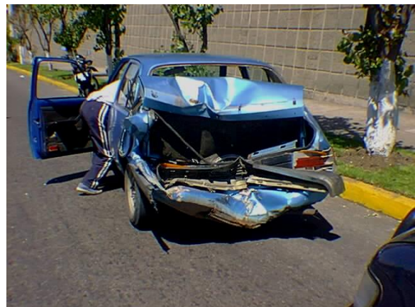
Figura 29. Choque por alcance. Impacto a alta velocidad. Destrucción total del porta maletas.
