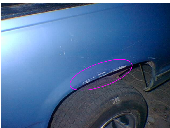
Figura 20. Rozamiento. Afectación de capa de pintura.
