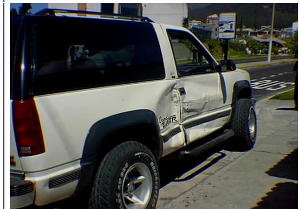
Figura 41. Choque lateral derecho perpendicular medio.
